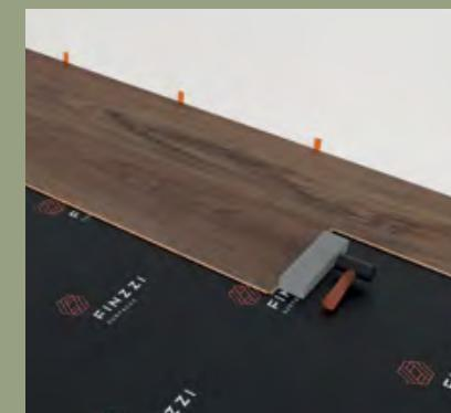
**Étape 8c:** Le produit est correctement verrouillé lorsque les deux planches sont alignées sur le dessus. Terminez l'installation de cette planche en la tapotant avec un bloc de taraudage sur le côté long pour assurer une installation sécurisée.
