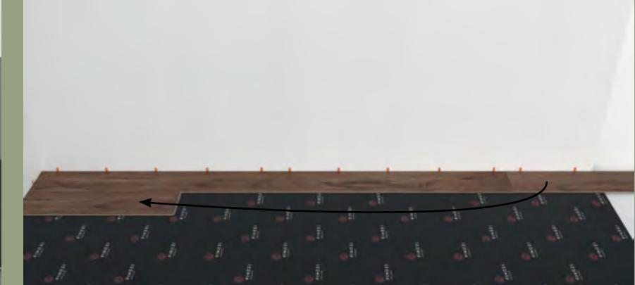
**Paso 6:** Comenzando la segunda fila, la primera tabla debe tener una longitud mínima de 10" (254 mm). Coloque un espaciador de 3/8" (9,525 mm) contra la pared y mida la última pieza. Si es más corto a 10" (254 mm), se debe usar una nueva pieza de arranque. Inserte en ángulo en la fila anterior y tóquelo (en el lado largo) con un taco de goma hasta que quede plano.
